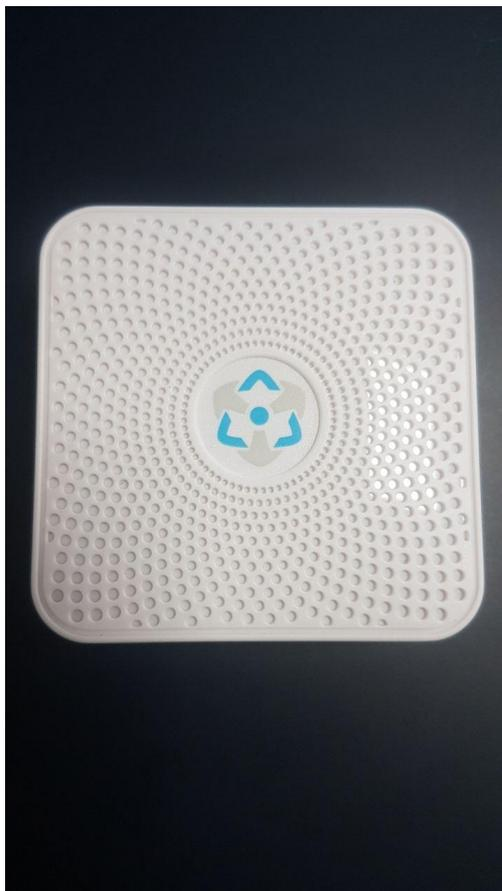
Рисунок 353. Датчик iBeacon
