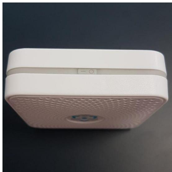
Рисунок 361. Кнопка включения iBeacon.
