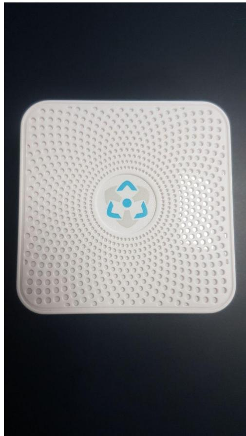
Рисунок 353. Датчик iBeacon
